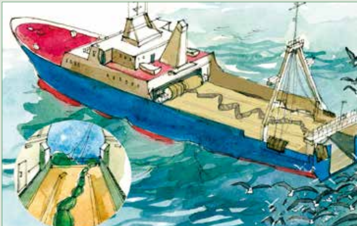
Figura 1. A amarração da rede reduz o tempo que a rede permanece na superfície.
